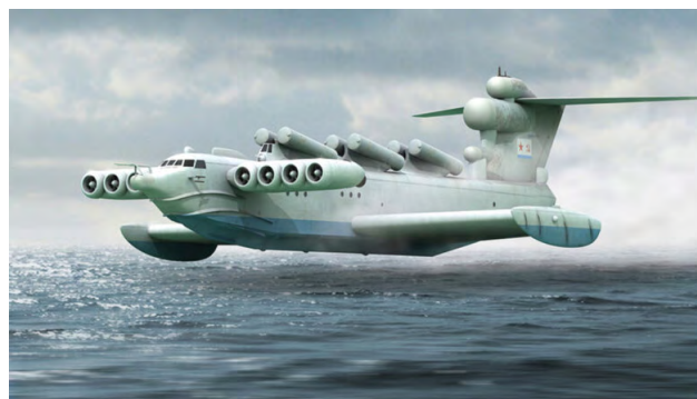
• Рис. 2. Ракетный экраноплан «Лунь» разработки «ЦКБ по СПК» • Fig. 2. Rockets carrier ekranoplan «Lun» developed by the Central Design Bureau for Hydrofoils
