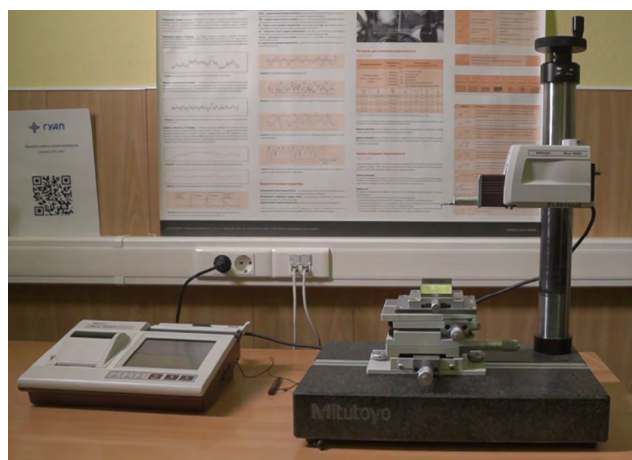
• Рис. 2. Портативный профилометр Mitutoyo SurfTest SJ-410
