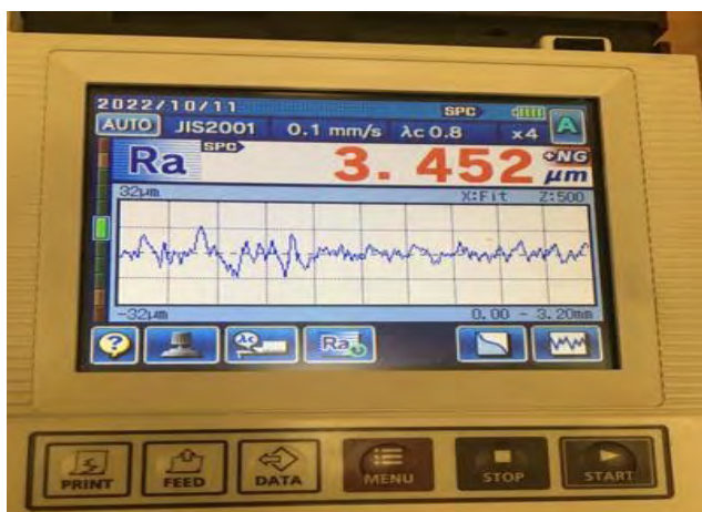
• Рис. 1. Профилограмма шероховатости поверхности – скриншот из программного обеспечения профилометра
