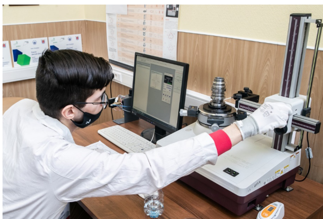
• Рис. 1. Работа на кругломере RoundTest RA-120P • Fig. 1. Working on a RoundTest RA-120P
