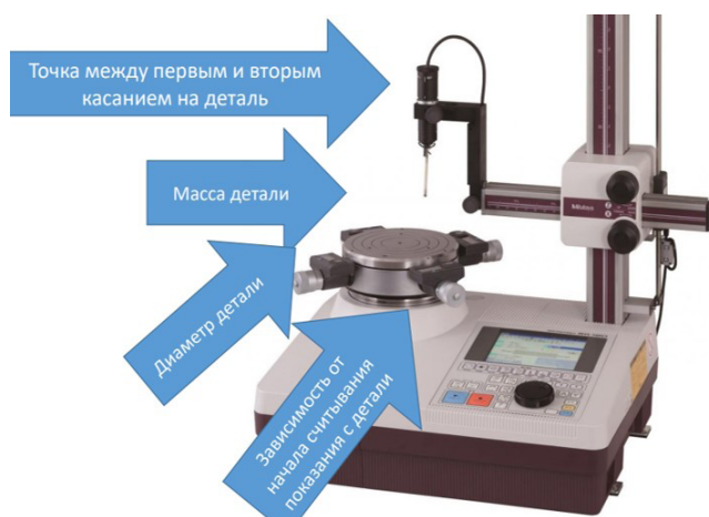
• Рис. 9. Дополнительные факторы, не учитываемые в стандартном процессе калибровки • Fig. 9. Additional factors not taken into account in the standard calibration process
