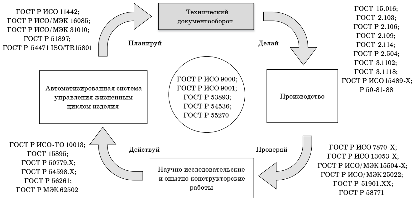
• Рис. 1. Технический документооборот как часть СМК наукоемкого производства • Fig. 1. Engineering document flow as part of the high-technology production quality management system
