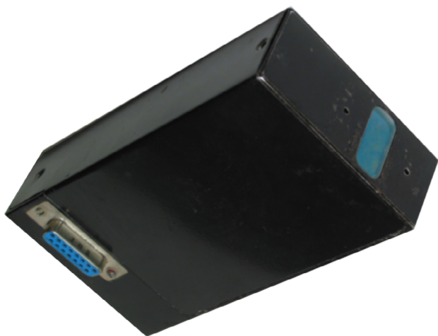
• Рис. 1. Внешний вид сканирующего интерференционного щупа • Fig. 1. The appearance of the scanning interference probe
