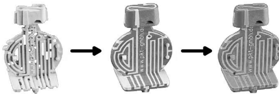
Рис. 3. Системы проводников на конструкциях изделий сложной формы
