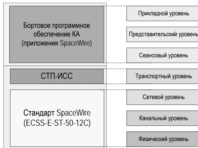
Рис. 1. Соотношение стека протоколов SpaceWire и протокола СТП-ИСС с моделью OSI
