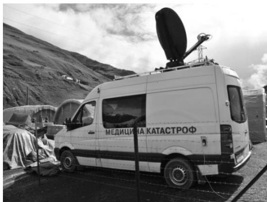
Рис. 2. Автомобиль с автоматизированным комплексом «iNetVu @1200»
