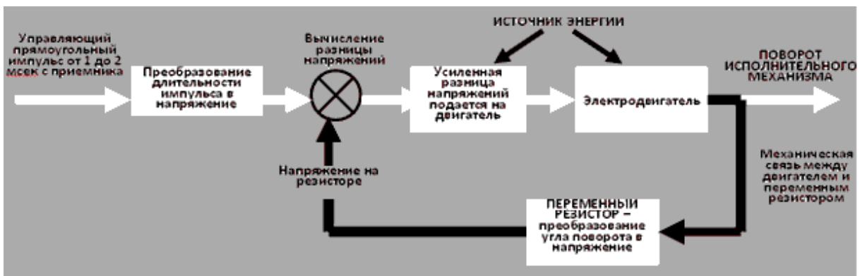
Рис. 2. Структурная динамическая схема сервопривода: 1– 3 провода – питание для мотора + и -, и управляющий сигнал; 2 – управляющая схема; 3 – датчик (потенциометр); 4 – электромотор; 5 – выходной вал.
