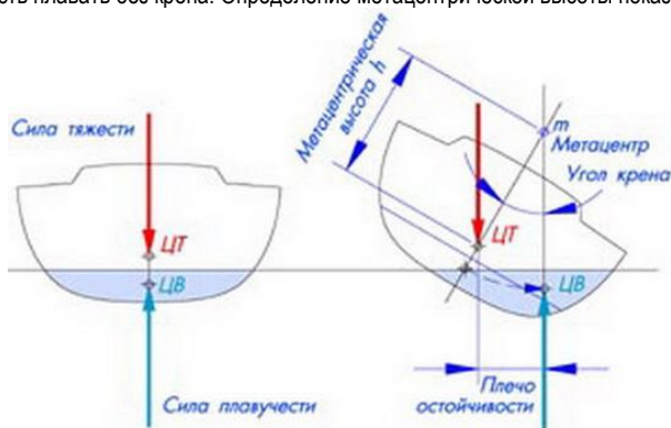
Рис. 1. Определение метацентрической высоты
