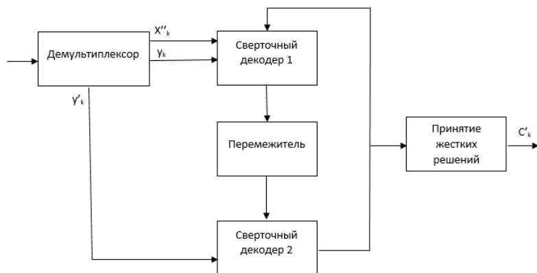
Рис. 2. Структурная схема декодера турбокода
