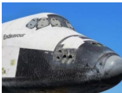
Рис. 3. Плиточная тепловая защита шаттла Индевор
