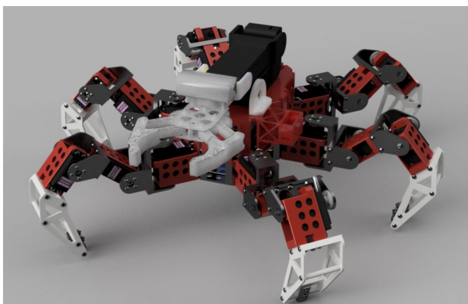
Рис. 2. Конструкция робота-гексапода с захватом
