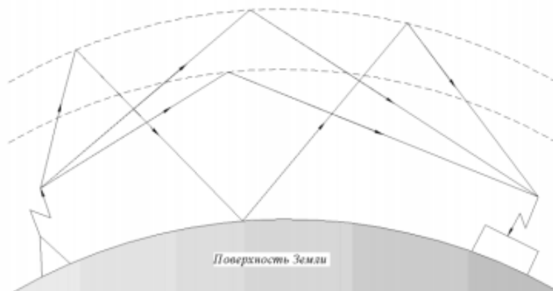
Рис. 1. Пример многолучевого распространения радиоволн
