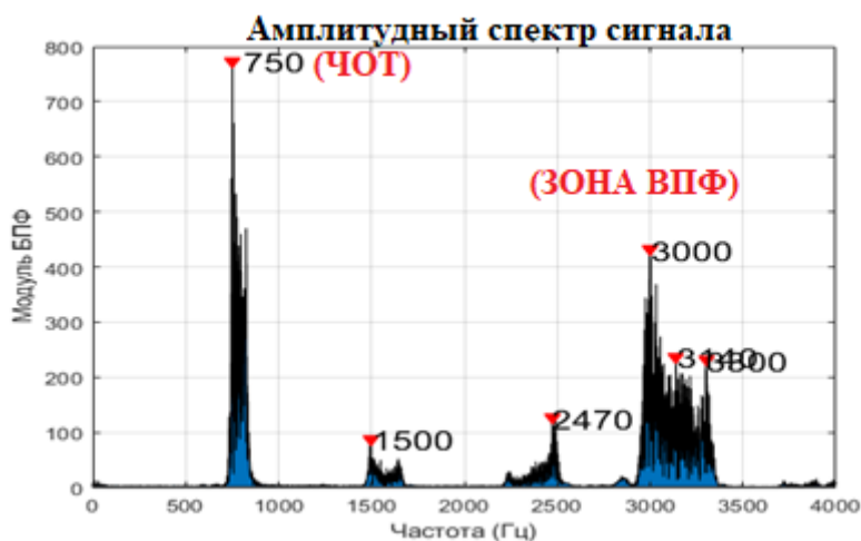
Рис. 2. Амплитудный спектр голоса Ольги Бородиной. ЧОТ – частота основного тона, E = 1.2381e+07 , E_{pf} = 6.1887e+06 , ВПФ = 0.4998
