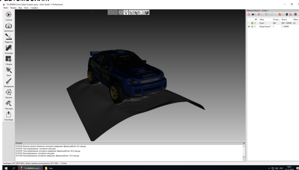
Рис. 4. 3D-модель автомобиля после обработки в окне программы ArtecStudio
