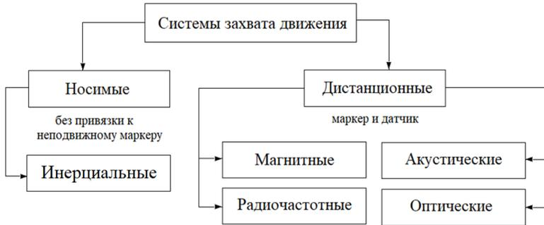
Рис. 1. Классификация систем захвата движения
