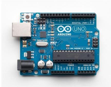
Рис. 2. Плата ArduinoUno
