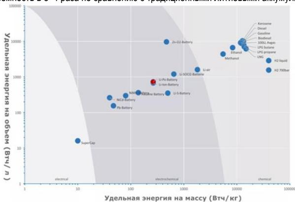
Рис. 1. Удельная мощность различных источников энергии
