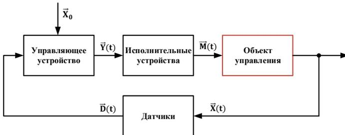
Рис. 1. Структурная схема системы управления с обратной связью
