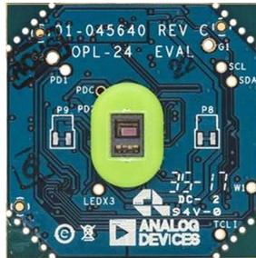
Рис. 3. Внешний вид интегрированного оптического модуля [7]
