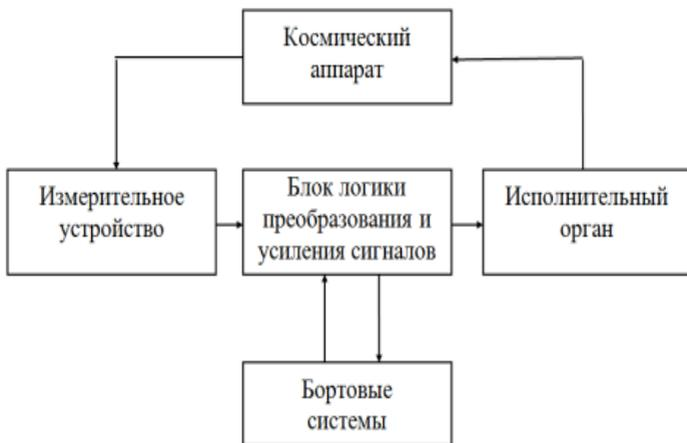
Рис. 1. Классическая структурная схема СУД
