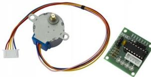
Рис. 3. Шаговый двигатель 28byj-48 с драйвером uln2003
