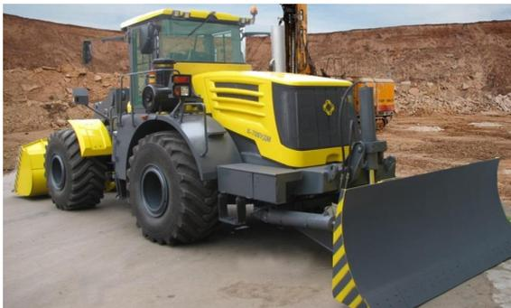
Рис. 4. Строительно-дорожный трактор К-708УДМ
