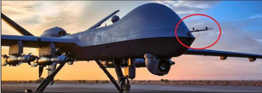
Рис. 3. Совмещенный ДАП (ПВД и датчик угла атаки) на БПЛА MQ-1 Predator
