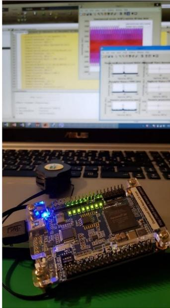
Рис. 7. Анализ спектра с использованием отладочной платы с ПЛИС и анализ спектра в программе Matlab
