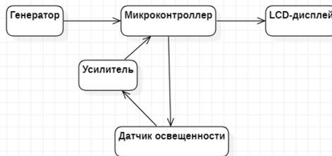
Рис. 1. Структурная схема люксметра
