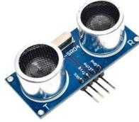
Рис. 4. Ультразвуковой дальномер HC-SR04
