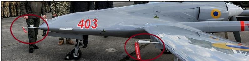
Рис. 2. Разнесенные ДАП на БПЛА Bayraktar TB2
