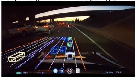
Рис. 2. Визуализация распознанной и классифицированной информации от разнородных датчиков на примере работы ПО компании Tesla (США)
