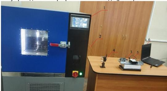
Рис. 1. Экспериментальный стенд: 1 – климатическая камера УП-64ТХВ; 2 – оптическое волокно; 3 – лазер; 4 – фокусирующая линза; 5 – спектрометр; 6 – компьютер
