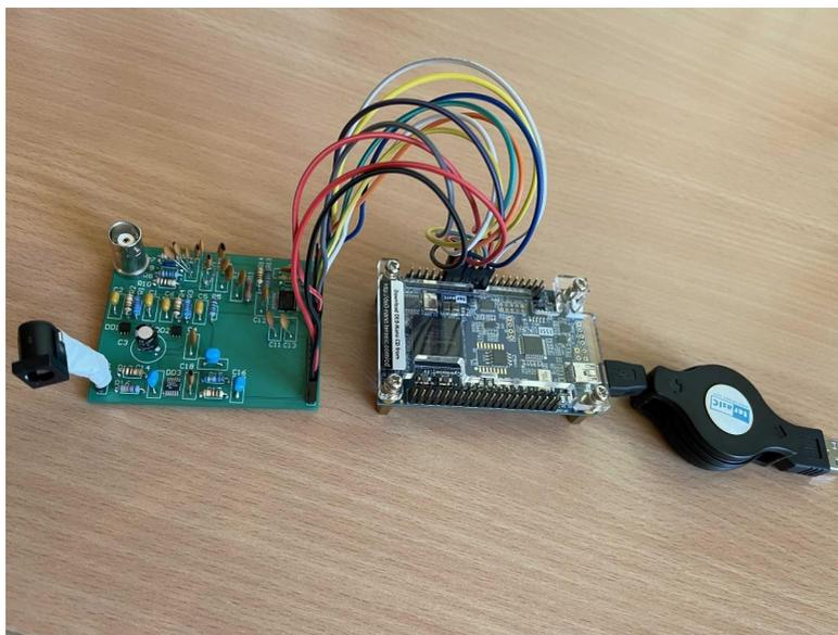
Рис. 6. Внешний вид цифрового анализатора спектра
