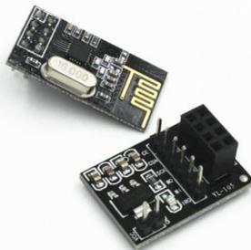
Рис. 6. Датчик nRF24l01 с адаптером
