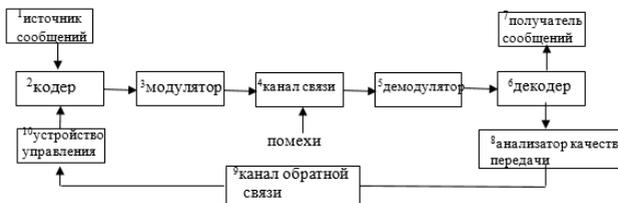
Рис. 1. Структурная схема адаптивной системы передачи данных
