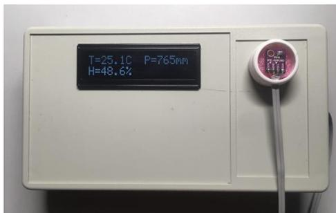
Рис. 3. Устройство для оценки относительной влажности кожного покрова
