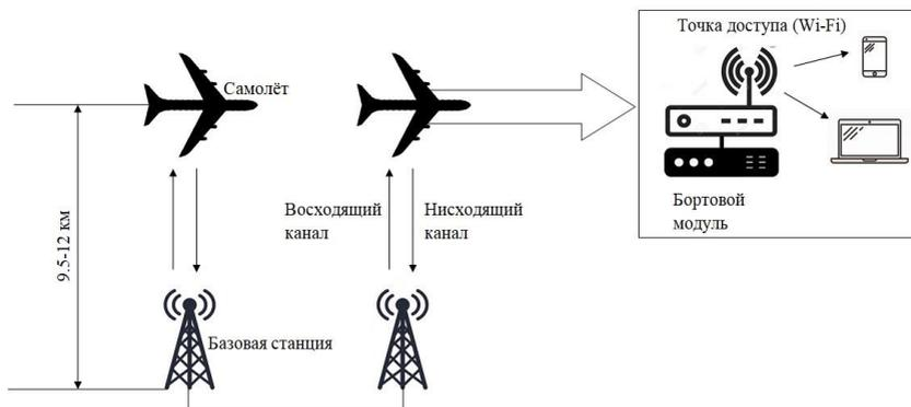
Рис. 1. Схема A2G системы
