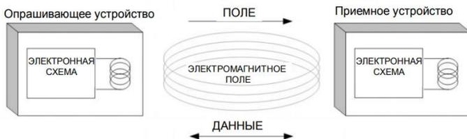
Рис. 1. Схема взаимодействия опрашивающего (инициатора) и приемного(адресата) устройств
