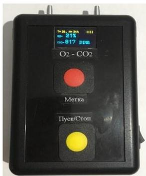
*Рис. 4. Внешний вид устройства для оценки кислорода и углекислого газа в замкнутом объеме с экспериментальным животным*
