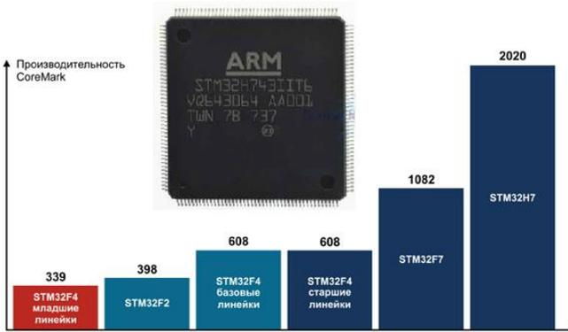
Рис. 2. Рост производительности MCU STM32
