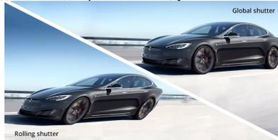
Рис. 6. Изображение автомобиля с Global Shutter и Rolling shutter
