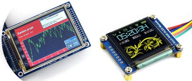
слева - TFT LCD дисплей, справа – OLED дисплей
