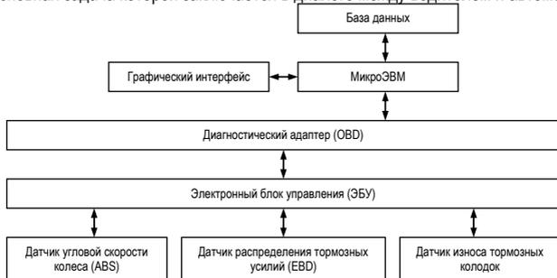
Рис. 1. Структурная схема интеллектуальной системы мониторинга технического состояния автотранспортного средства
