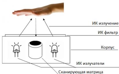
Рис. 1. Схематичное устройство сканера вен ладони
