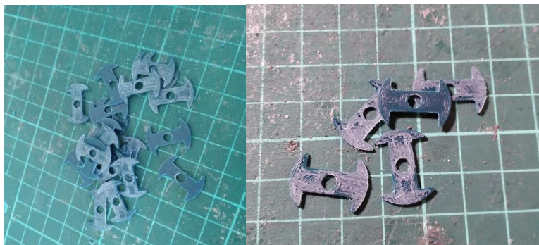
Рис. 3. Процесс создания макета якоря из композитного материала с использованием феррита
