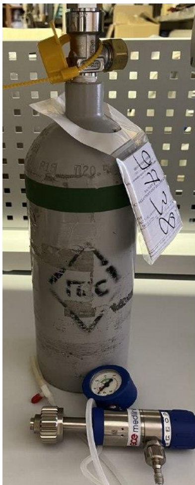
Рис. 5. Баллон с водородом концентрации 20 ppm
