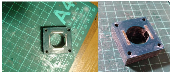
Рис. 2. Готовый макет статора из композитного материала с использованием феррита
