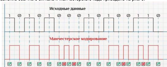
Рис. 3. Пример манчестерского кода [4]
