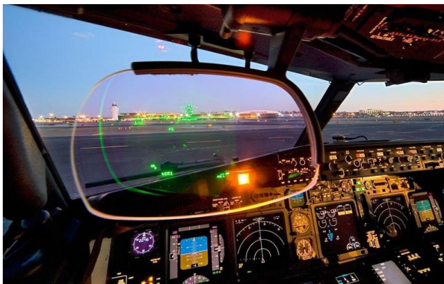
Рис. 4. Проекционный экран в кабине пилота самолета
