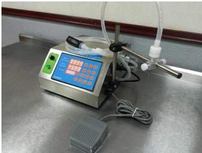
Рис. 2. Автоматизированная система на мембранном насосе
