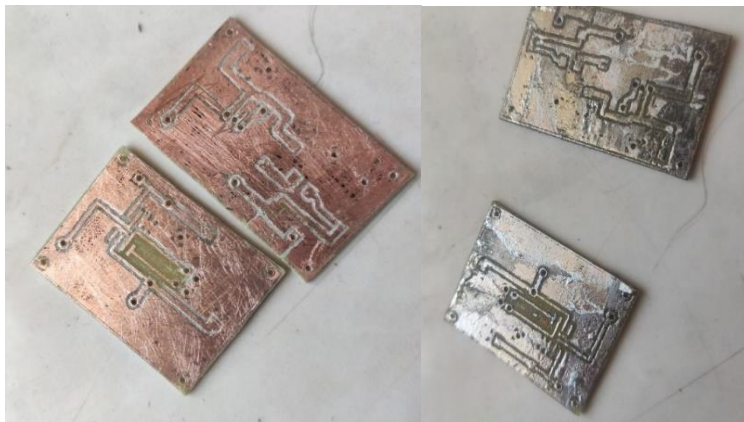
Рис. 2. Вытравленные платы и покрытые оловянно-свинцовым припоем
