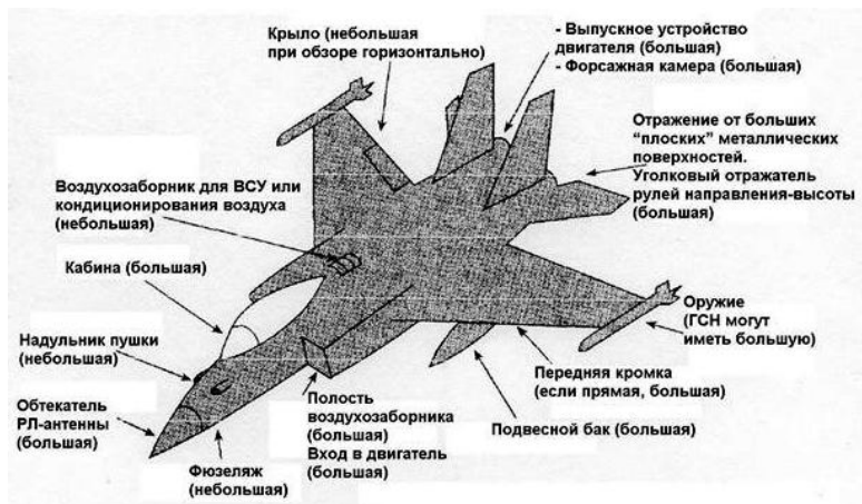
Рис. 7. Качественная оценка вклада, вносимого в величину ЭПР различными элементами планера ЛА и самолетных систем
