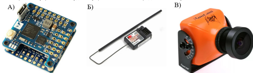
Рис. 12. БРЭО: А – полетный контроллер; Б – передатчик; В – FPV-камера
