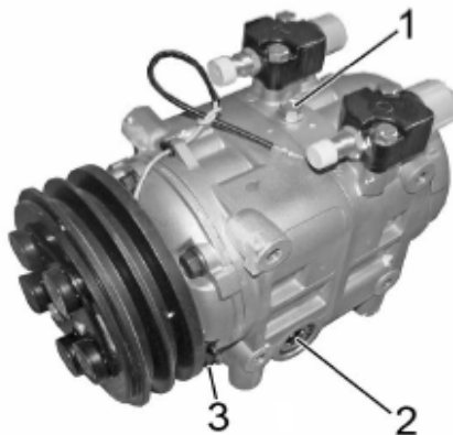
Рис. 1. Проверка уровня масла компрессора: 1 – пробка заливного отверстия; 2 – смотровое окно; 3 – пробка сливного отверстия
