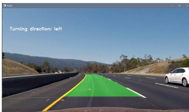
Рис. 6. Пример работы системы распознавания разметки при использовании алгоритма Хафа
