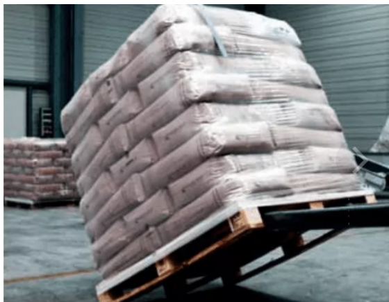
Рис. 3. Стекловата, упакованная по системе Stretch-hood
