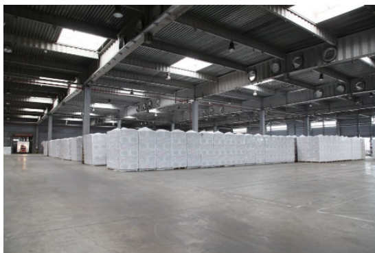
Рис. 2. Хранение стекловаты в закрытом складе, упакованной по системе Stretch hood
