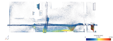
Рис. 10. Векторное отображение скоростей потоков газов в горизонтальном сечении помещения
