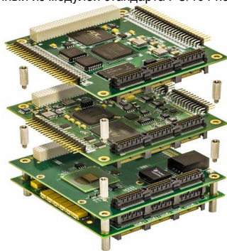
Рис. 1. Сборка компьютера формата РС/104 [1]
