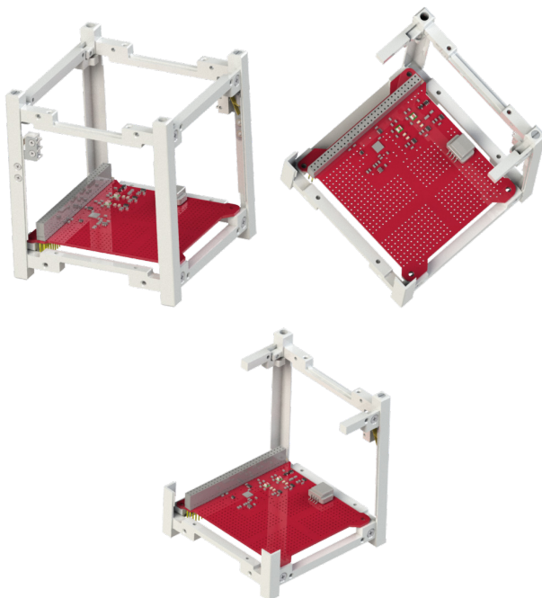
Рис. 4. Размещение платы SXC-MBB-03 [5] стандарта PC/104 в корпусе 1U CubeSat SXC-F1U-02 [6]
