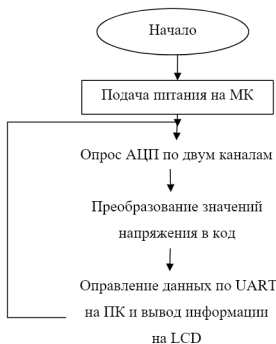
Рис. 3. Алгоритм работы программы микроконтроллера
