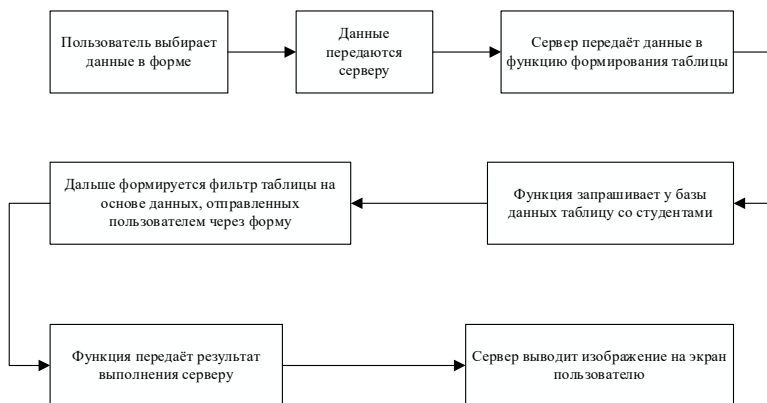
Рис. 6. Схема взаимодействия пользователя, сервера и базы данных
