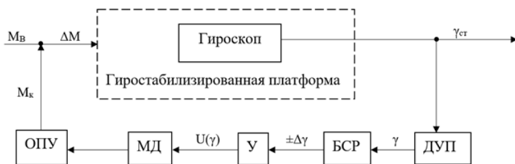
Рис. 1. Структурная схема гиростабилизированной платформы
