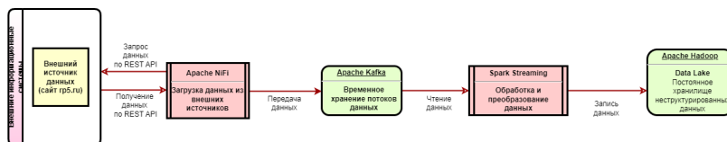
Рис. 1. Схема обработки данных
