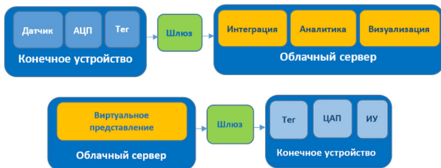
Рис. 2. Передача данных с устройства в облако и обратно
