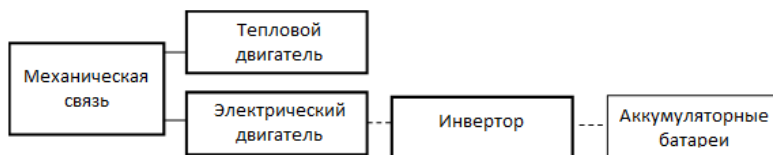
Рис. 1. Структурная схема параллельной системы гибридной силовой установки летального аппарата
