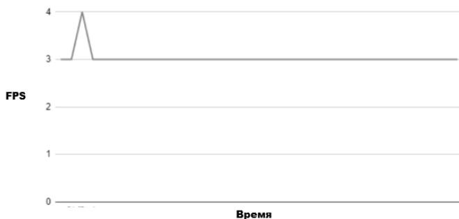
Рис. 8. График кадров в секунду за единицу времени при количестве объектов 10000
