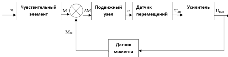
Рис. 1. Структурная схема акселерометра
