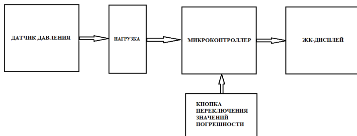
Рис. 1. Структурная схема цифрового манометра
