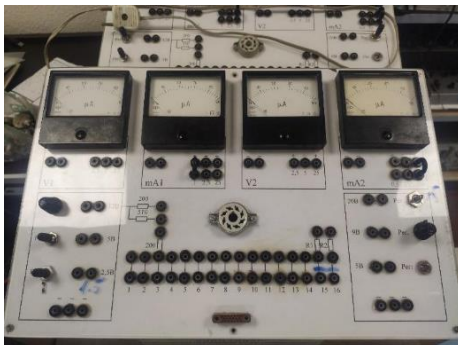
Рис. 1. Лабораторный макет по исследованию полупроводниковых приборов
